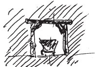
eerste profiel met houten stutten
